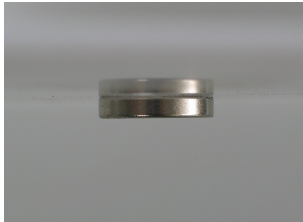
(Abb. 25: Ringmagnet gehalten von Eisenspänen an Kunststoffplatte)
