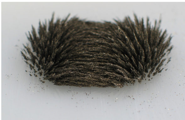
(Abb. 26: Eisenspäne auf einer Kunststoffplatte mit Quadermagnet)
