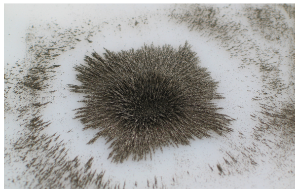
(Abb. 27: Eisenspäne auf einer Kunststoffplatte mit Quadermagnet)
