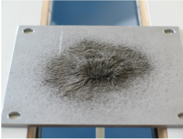
(Abb. 22: Eisenspäne auf einer 2mm Stahlplatte mit Magnet drunter)
