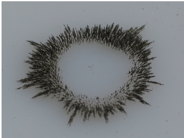
(Abb. 24: Eisenspäne auf einer Kunststoffplatte mit Ringmagnet)
